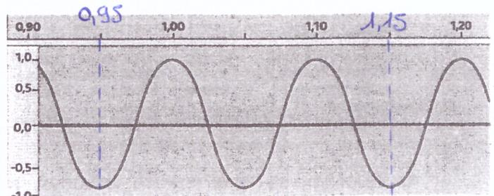
*Je compte 2 vibrations en 0,2 s donc en 1 seconde il y aurait 10 vibrations. Le signal a donc une fréquence de 10 Hz.*
